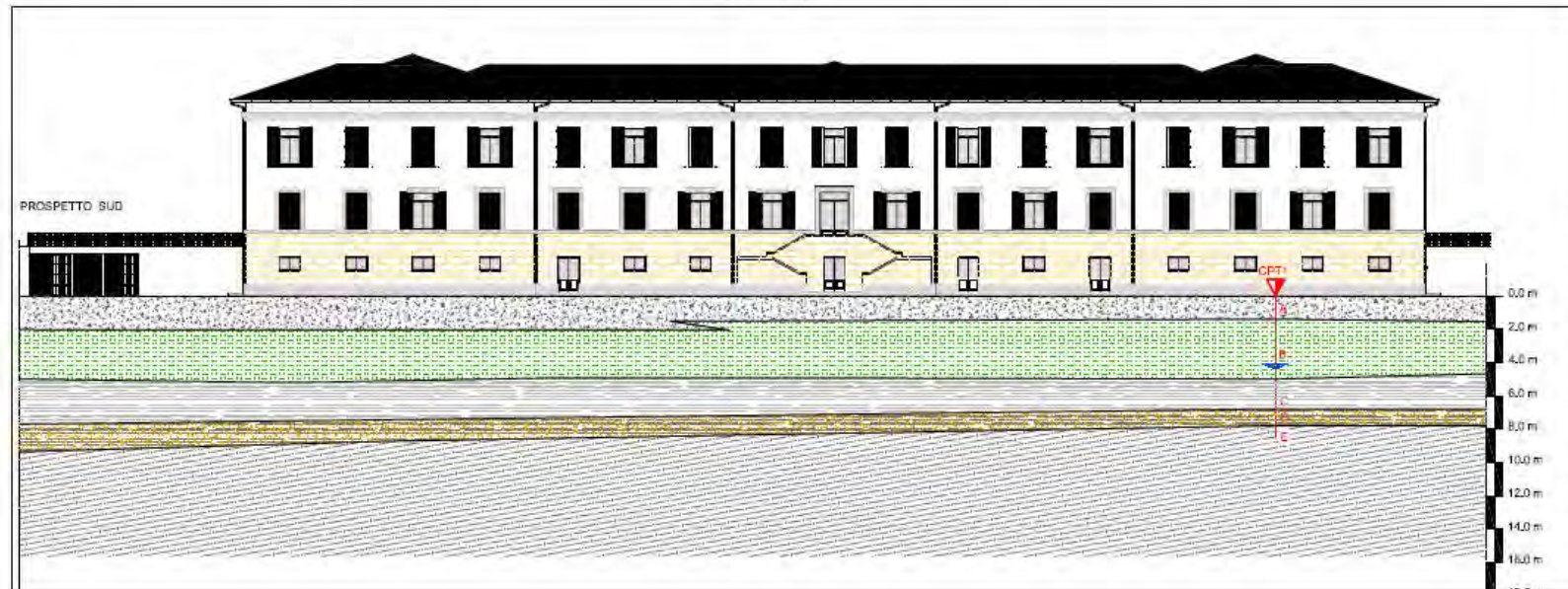
FIG.4 A - SEZIONE LITOSTRATIGRAFICA INTERPRETATIVA SU PROSPETTO SUD (Scala 1: 250)
