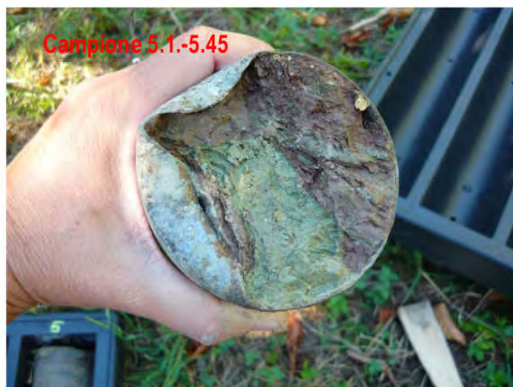
Foto 7_Vista del campione C2 (prof 5.10-5.45 metri) con evidenti frammenti litici (argilliti) in matrice limo argillosa addensata.
