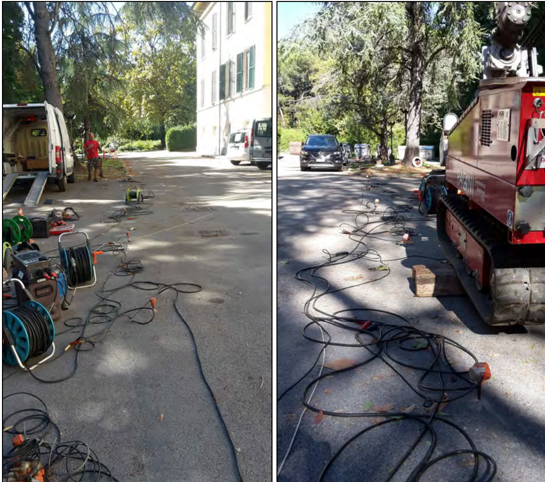
Profilo ST1 – Sito d'indagine durante l'esecuzione delle indagini sismiche. Foto a destra: stendimento di 48 geofoni verticali con interspazio dx=2.5 metri. Sulla sinistra dall'immagine è visibile il sismografo Geometrics Stratavisor NPXZ, utilizzato per la registrazione del segnale sismico. Foto a sinistra: stralcio della linea sismica durante le acquisizioni con le onde di taglio SH.
