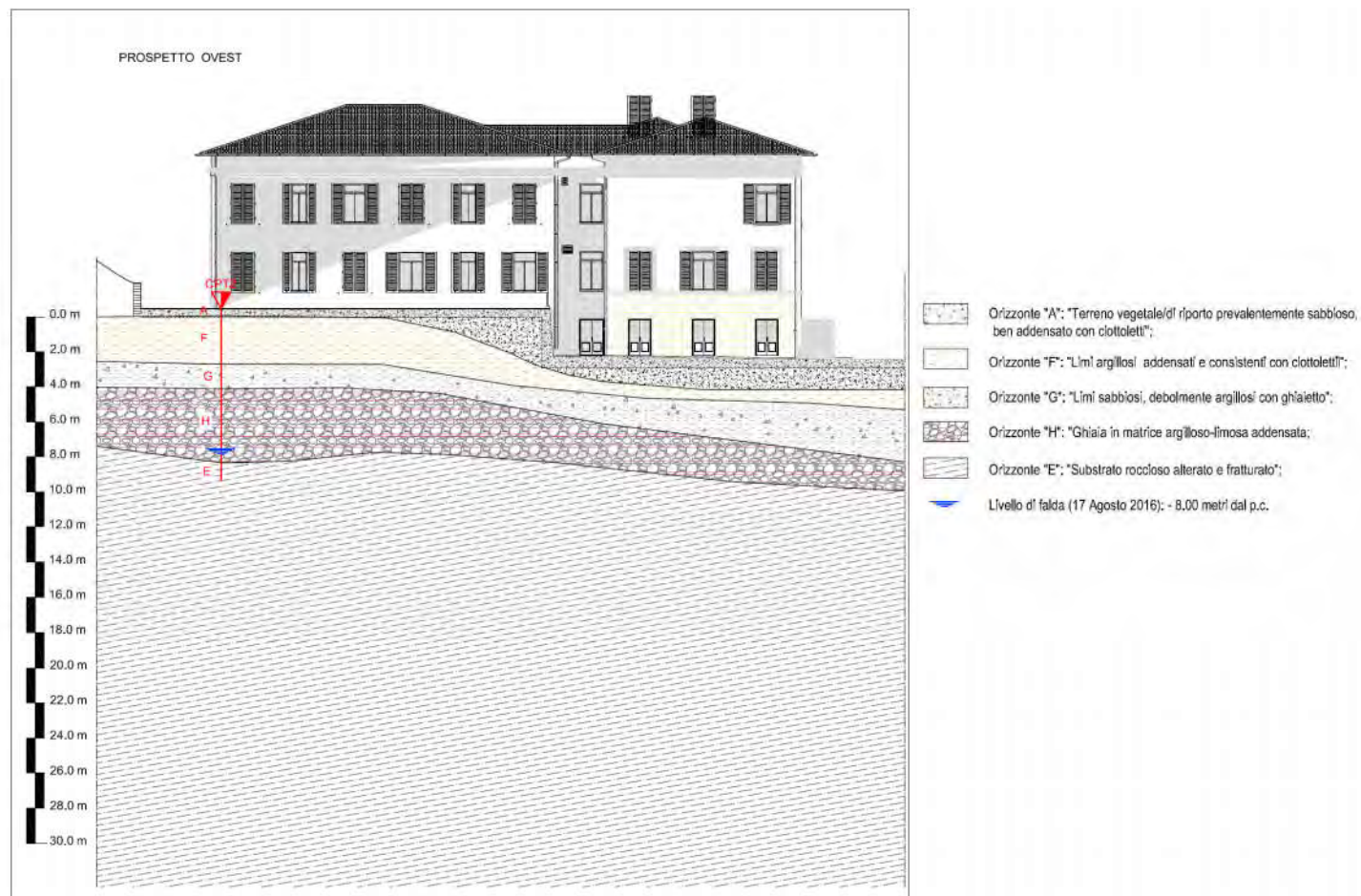
FIG.4 B - SEZIONE LITOSTRATIGRAFICA INTERPRETATIVA SU PROSPETTO OVEST (Scala 1:200)
